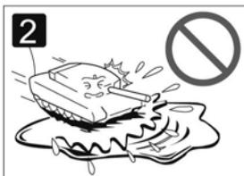
2 Si de l'humidité s'infiltré dans le tank (ou sa radiocommande) pendant son fonctionnement et qui engendre des dysfonctionnements ou une panne.
