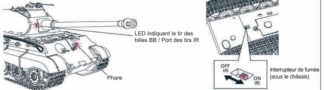
2. En fonctionnement, pressez l'interrupteur de la mitrailleuse **G** et le tank doit émettre le son du tir de la mitrailleuse. Pressez l'interrupteur du tir du canon **K** et le tank doit simultanément émettre le son du tir et simuler le recul produit par le canon. L'utilisateur peut faire fonctionner en même temps les tirs de la mitrailleuse et du canon.
