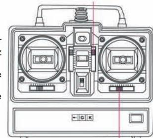
**Indication particulière :** Vous pouvez régler le trim de marche avant/arrière pour permettre au tank de rester à l'arrêt lorsque vous ne touchez pas au manche des gaz (marche avant/arrière). Vous pouvez régler le trim de direction pour permettre au tank de rouler droit lorsque vous faites une marche avant/arrière. Le tank se dirigera vers la droite si le trim de direction est placé vers la gauche et le tank se dirigera vers la gauche si le trim de direction est placé vers la droite.
